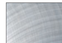
▲6面フライス2面研削仕上げの表面
